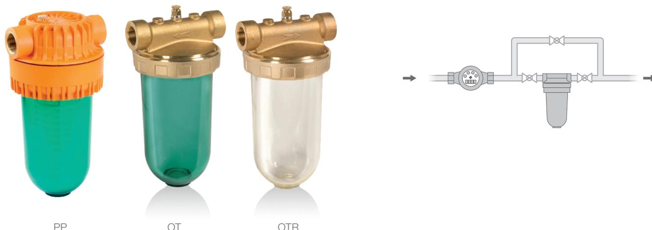
I Depura 700 sono filtri di sicurezza standard che eliminano dall'acqua sabbia e corpi estranei e sono utilizzati per impieghi civili, tecnici ed industriali. Si costituiscono di testa in ottone o polipropilene e vaso in materiale plastico SAN, resistente a pressioni elevate o trogamid, resistente anche a temperature elevate. I filtri Depura 700 possono alloggiare le seguenti tipologie di cartucce filtranti:
