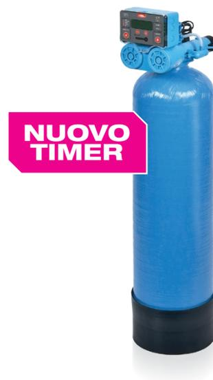
I Desabb sono filtri a colonna chiarificatori, utilizzati per eliminare la torbidità dell'acqua. Le impurità accumulate dalle masse filtranti devono essere periodicamente rimosse con un lavaggio controcorrente. La frequenza del controlavaggio è programmabile in modalità tempo. Il dimensionamento di un impianto va fatto sulla base della portata richiesta dall'utente e della torbidità presente nell'acqua da trattare.
