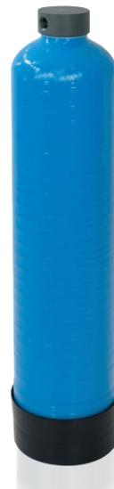
I Dearsenic sono filtri a colonna dearsenificatori a resine selettive, utilizzati per trattenere l'arsenico presente nell'acqua (concentrazione max stabilita dal D.L. 31/2001 è di 10 µg/l). Il dimensionamento di un impianto va fatto sulla base della portata richiesta dall'utente e della concentrazione di arsenico.
