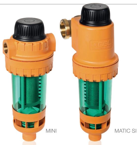
I Depura Mini e i Depura Matic sono filtri di sicurezza autopulenti manuali, per acqua di rete. Ad uso civile, tecnico e industriale, questi filtri sono un'alternativa ai filtri tradizionali. Il regolare lavaggio, abbinato ad un'efficace spazzolatura meccanica, mantiene pulita la cartuccia filtrante che, così, non necessita della manutenzione periodica. La pulizia si effettua ruotando manualmente la manopola superiore.
