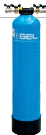
Il filtro defangatore Thermo Filter è un filtro chiarificatore (letto di quarzite) e defangatore per circuiti chiusi di riscaldamento e raffreddamento. Il filtro defangatore Thermo Filter elimina tutte le impurità presenti all'interno dei circuiti chiusi. Viene installato in derivazione sul ritorno del circuito.
