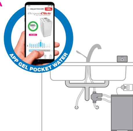
Sistema brevettato ad osmosi inversa con produzione diretta, in grado di migliorare la qualità dell'acqua del rubinetto rendendola ottima per bere e cucinare.
