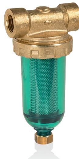
I Depura Baby sono filtri di sicurezza standard che eliminano dall'acqua sabbia e corpi estranei e sono utilizzati per impieghi civili, tecnici ed industriali. Si costituiscono di testa in ottone e vaso in materiale plastico SAN, resistente a pressioni elevate. I filtri Depura Baby sono completi di cartuccia filtrante a rete lavabile in acciaio inox da 90µm, idonea per applicazioni tecnico-potabili. Ideali in situazioni di spazio ridotto
