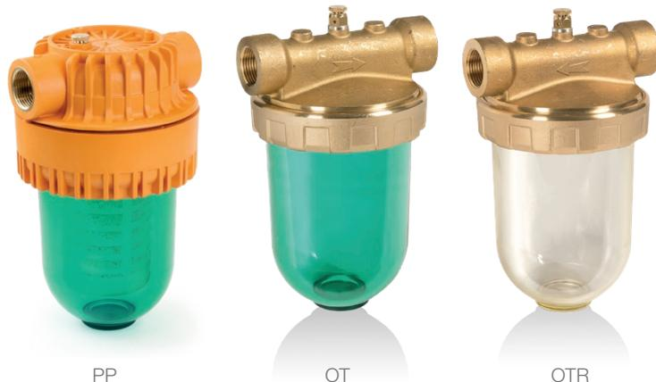
I Depura 550 sono filtri di sicurezza standard che eliminano dall'acqua sabbia e corpi estranei e sono utilizzati per impieghi civili, tecnici ed industriali. Si costituiscono di testa in ottone o polipropilene e vaso in materiale plastico SAN, resistente a pressioni elevate o trogamid, resistente anche a temperature elevate. I filtri Depura 550 possono alloggiare le seguenti tipologie di cartucce filtranti:
