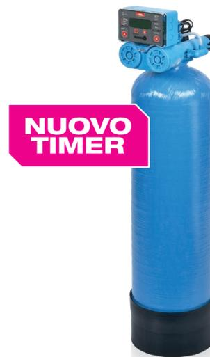
I Neutral sono filtri a colonna neutralizzatori a dolomite, utilizzati per aumentare la durezza e/o il pH dell'acqua. Le vie preferenziali create dall'acqua sulle masse filtranti richiede un loro periodico lavaggio controcorrente. La frequenza del controllavaggio è programmabile in modalità tempo. Il dimensionamento di un impianto va fatto sulla base della portata richiesta dall'utente.
